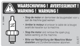
Dieser Aufkleber ist in Höhe des Motors am Gerät angebracht. Er weist Sie darauf hin, dass Sie den Motor abstellen und die Zündkerzenkappe abziehen müssen, bevor Sie Wartungsarbeiten am Gerät durchführen.
