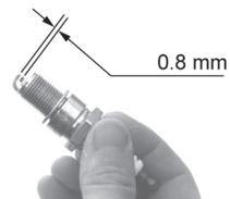
zwischen den Elektroden 0,8 mm beträgt.
